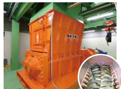
粗破砕機 ゆっくりと回転する刃でごみをだまかに破砕し、その後の処理をスムーズにします。
