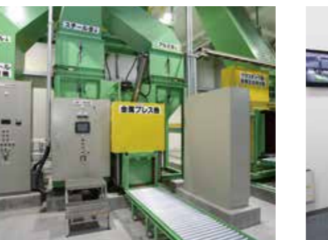
金属プレス機 回収されたスチール缶やアルミ缶を別々に圧縮成型後、場外搬出します。
