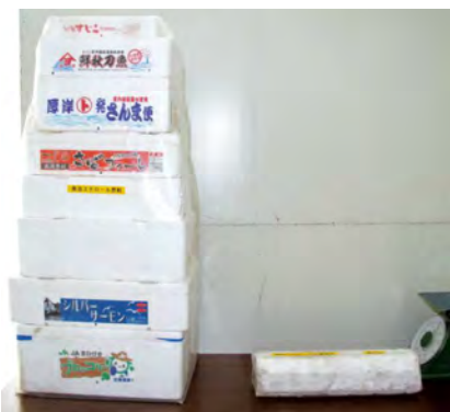
▲砕いて圧縮し成形された発泡スチロール。左が圧縮前、右が圧縮後。
