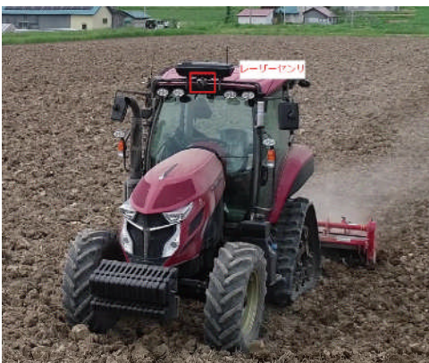
無人で耕起作業をするロボットトラクター
