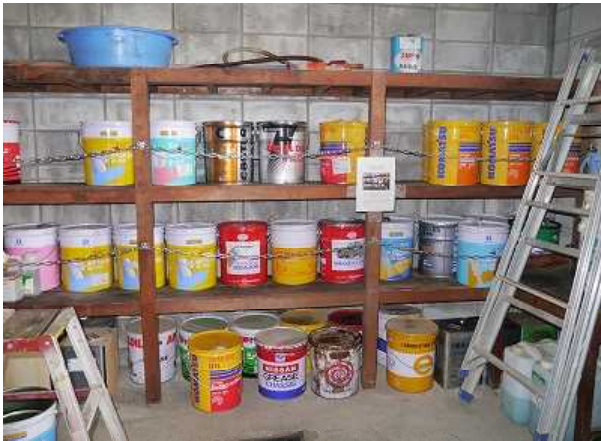
③転倒防止対策を行った燃油の保管
