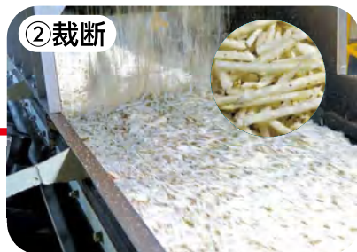
②裁断 ▲裁断機にかけ、糖分を抽出しやすいよう太さ4~5mmのスティック状に切る
