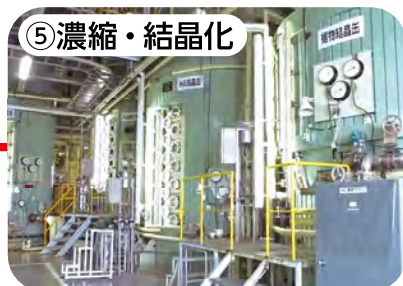
⑤濃縮・結晶化 ▲濃縮機で水分を蒸発させて3~4倍に濃縮し、結晶缶で結晶化させる
