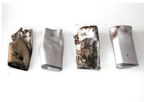
▲一般ごみに混ざって捨てられていた加熱式たばこ。処理中に破損して発火したため、焦げ跡が残っている。処理機の故障にもつながる。
