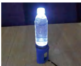
◀懐中電灯とペットボトルで、簡易ランプが作れます
