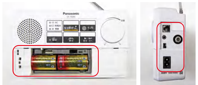
▲パネル下の電池入れは、専用ソケットで単1~3電池が入ります。
